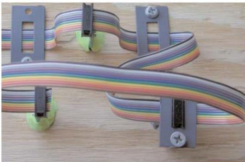
Ici des plaques métalliques de Signal sont employées pour tordre le Câble de Commande de Signal sous le réseau pour placer les connecteurs dans la bonne orientation pour l'installation des signaux. Le dernier connecteur sur le Câble de Commande de Signal est tenu en place avec seulement du mastic.
