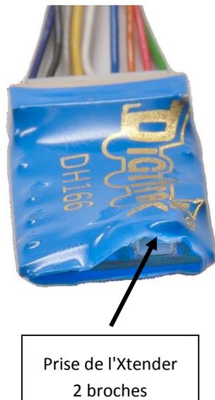
**Figure 2: Installation du PX112-2 Power Xtender**
